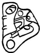
**Рис-16.** Стандартный зажим с подпружиненным кулачком (Standard Sprung-Cam Jammer).
