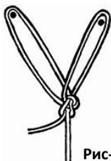
Рис-102 - Y-закрепление.
