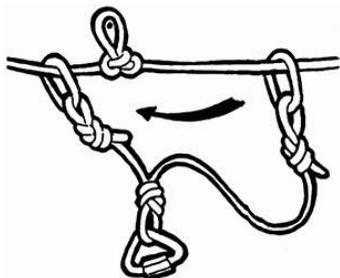
**Рис-42** – Использование обоих усов на перилах.
