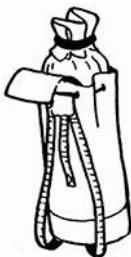
**Рис-23.** Стандартный мешок для снаряжения с двумя лямками (Standard Twin-Strap Tackle Sack)
