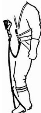
**Рис-19.** Педаль из нейлоновой веревки диаметром 8-9 мм, объединенная со страховочным соединением (safety link).
