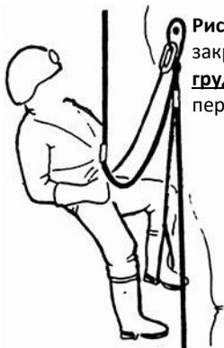
**Рис-40** – Промежуточное закрепление, перестежка грудного зажима в первую очередь.
