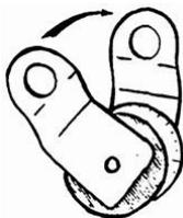
**Рис-20.** – Ролик с поворотнo открывающимся корпусом (Swing-Cheek Pulley)
