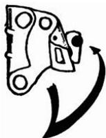
Рис-34. Предохранитель в открытом положении.
