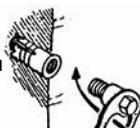
**Рис-68** «Боллард» – веревка ложится непосредственно на болт, устраняя любые нежелательные рычаги со стороны ушка.
