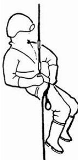
**Рис-32.** – Для спуска через узел используются оба зажима.
