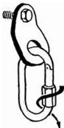
**Рис-66** Карабин с муфтой, направленной защелкой вниз и от стены.
