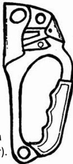
**Рис-17.** Ручной зажим (Handled Jammer).
