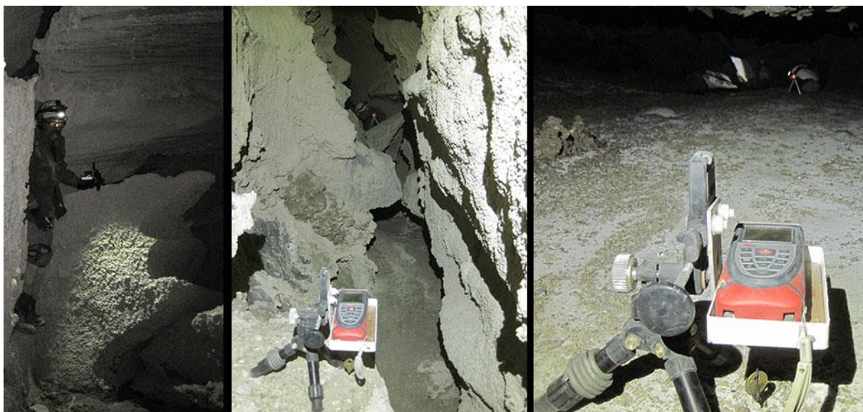
Рис.34. Съемка в разных условиях пещеры с помощью описываемой методики.
