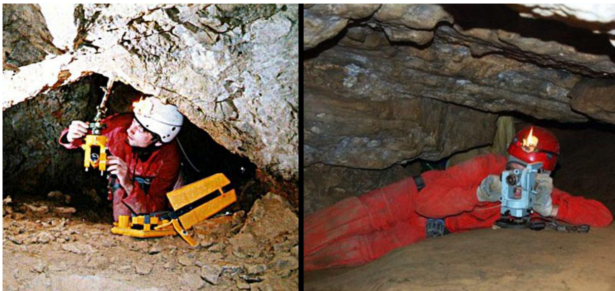
Рис.10. Теодолитная съемка в пещерах, слева – фото из Интернета, присланное Б.Максимовым, спелеоклуб «Подолье», Тернополь; справа – пещера Киндерлинская, Урал (фото ник eхrtem56 - http://photoshare.ru/photo10812756.html ).
