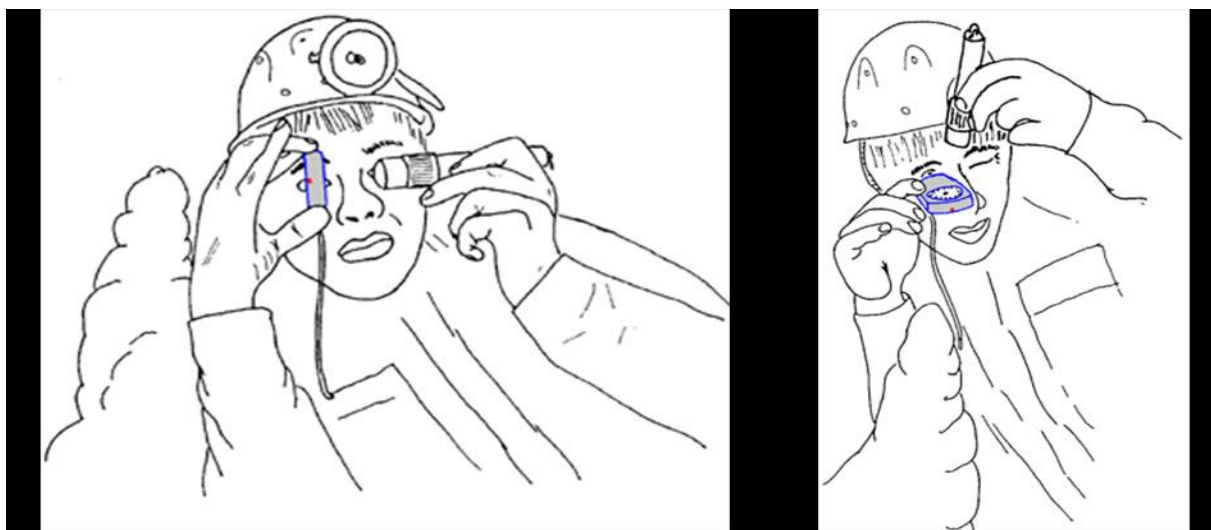
Рис.9. Съемка компасом и клинометром «Suunto», популярными в спелеологии (рисунки из книги «Vertical» by Alan Warild, Australia, 2007).
