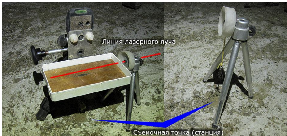
Рис.28. Проверка одинаковости высоты расположения над станцией базы инструмента и центра мишени, и установка мишени.
