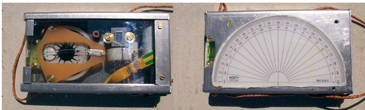
Рис.04. Топофил системы Пьера Риаса производства спелео-группы «Volcain», 2000 год.
