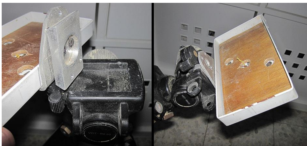
Рис.18. Вариант крепления платформы к головке типа «ласточкин хвост» штатива «Sony VCT R620».
