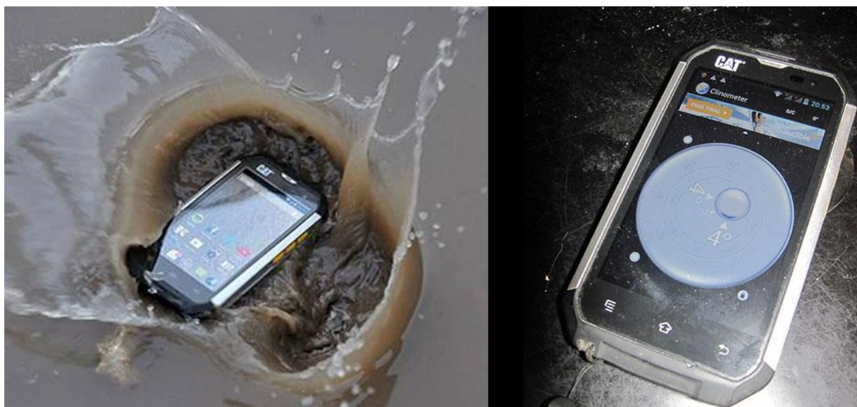
Рис.12. Смартфон «Caterpillar B15» и программа «Clinometer» для ОС Android
