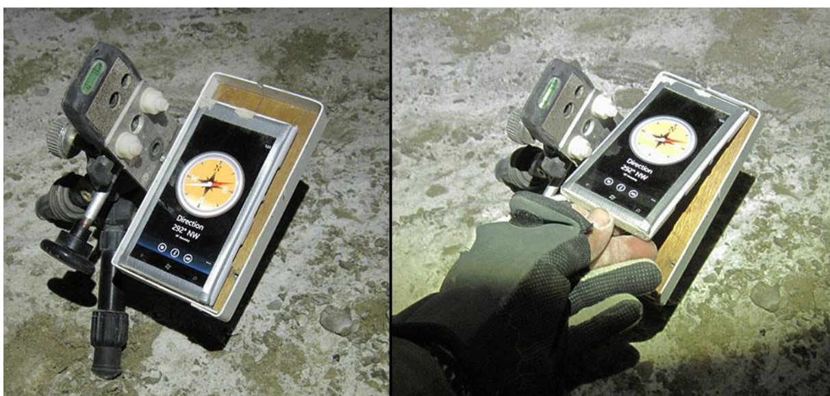
Рис.30. Измерение азимутов при больших уклонах.
