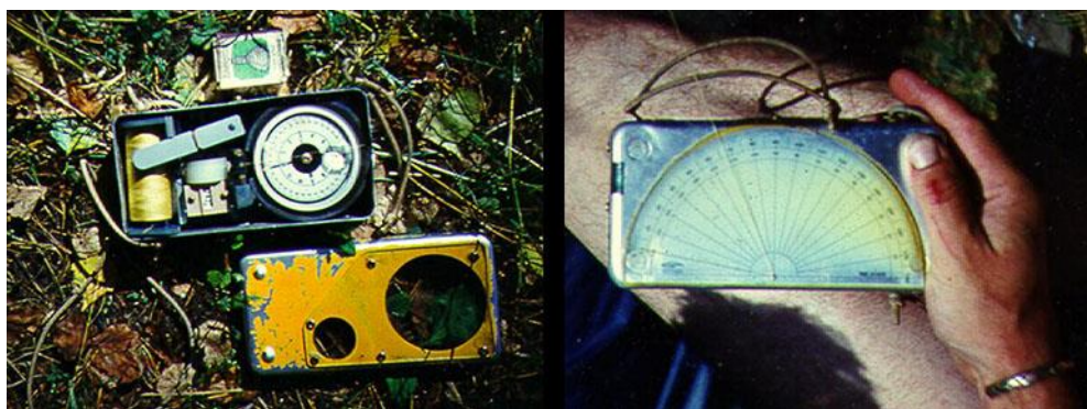
Рис.05. Топофил польского спелеолога Кристиана Парма ( Cristian Parma ), экспедиция Кутук-Сумган, август, 1988 год.
