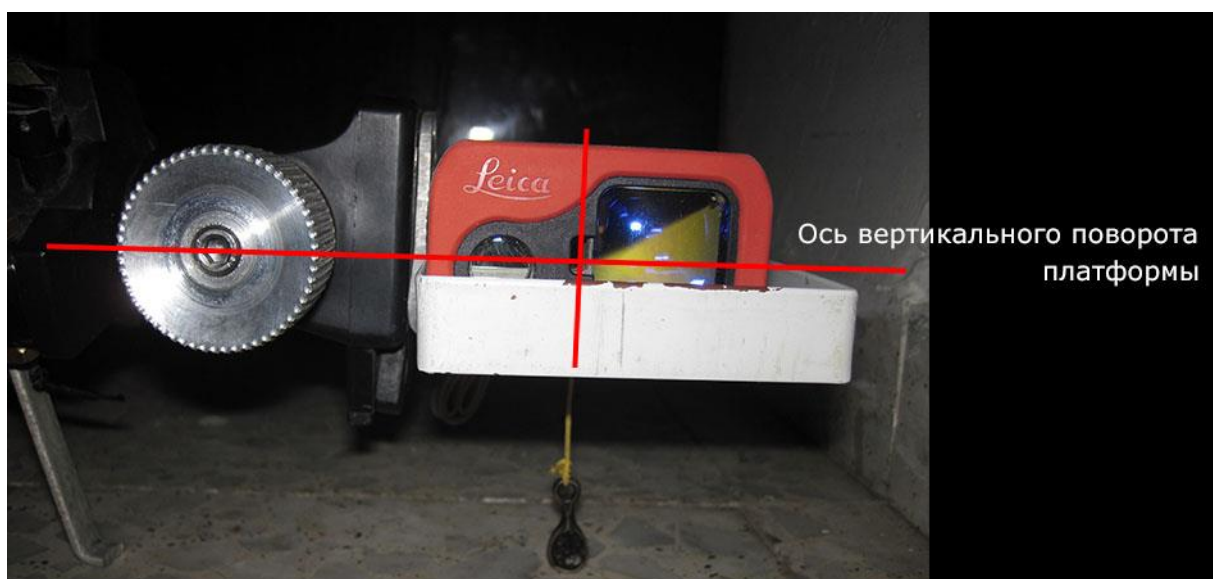
Рис.23. Расположение дальномера относительно оси вертикального поворота платформы на большом штативе в лежачем положении: ось параллельна платформе и проходит через виртуальную линию лазерного луча в окошечке излучателя.
