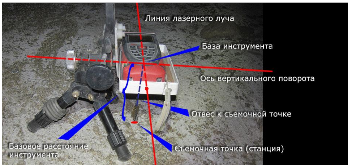
Рис.25. Расположение дальномера на платформе мини-штатива: все три оси (вертикального поворота, лазерного луча и отвеса от базы инструмента до станции) проходят перпендикулярно друг другу через базу измерительного инструмента.
