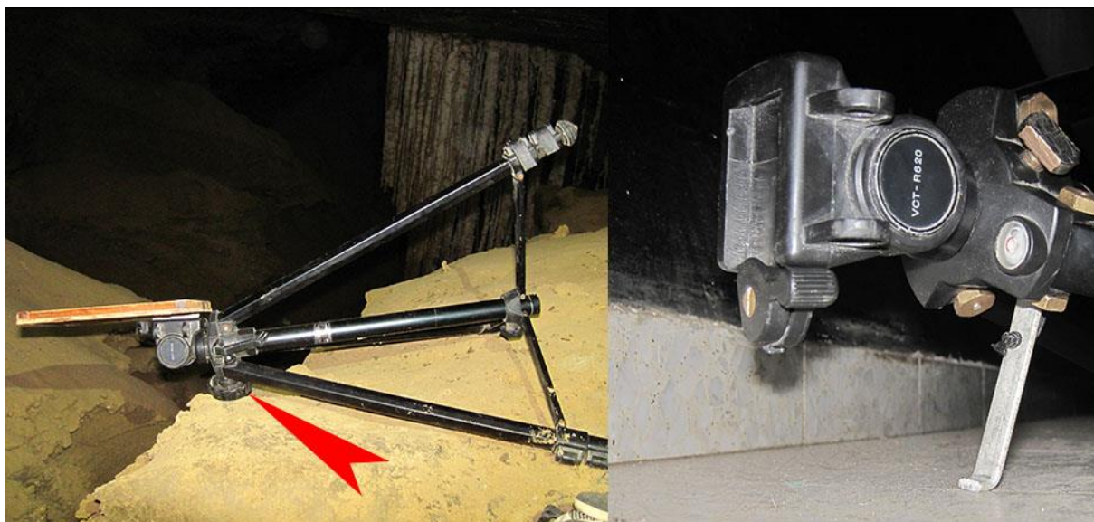
Рис.20. Обеспечение базового расстояния при лежащем большом штативе:
