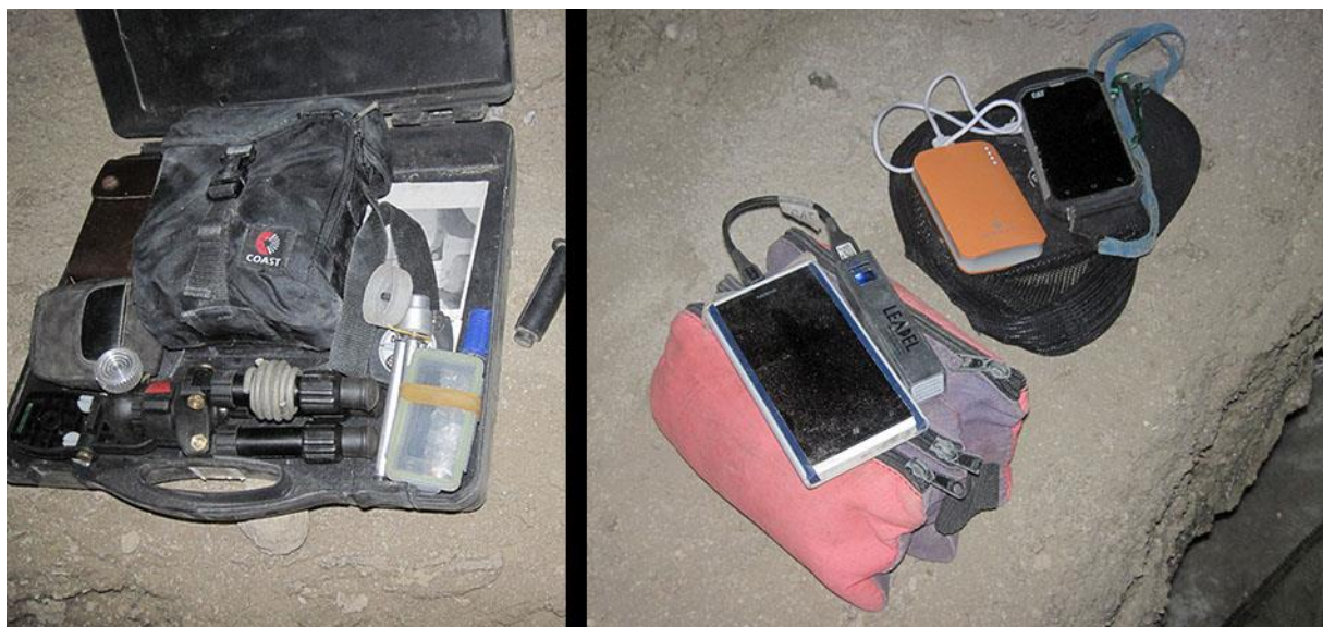
Рис.30. Транспортировка и обслуживание электронных инструментов для топосъемки слева – наш обычный набор топо-инструмента в пластиковом кофре во время транспортировки; справа – подзарядка смартфонов с помощью пауэр-банков с ПБЛ.
