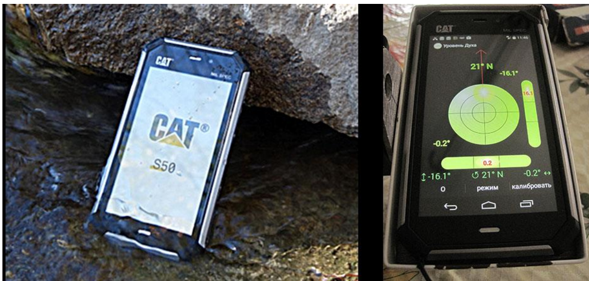
Рис.14. Смартфон Cat S50 и программа «Spirit Level & Compass» в действии.
